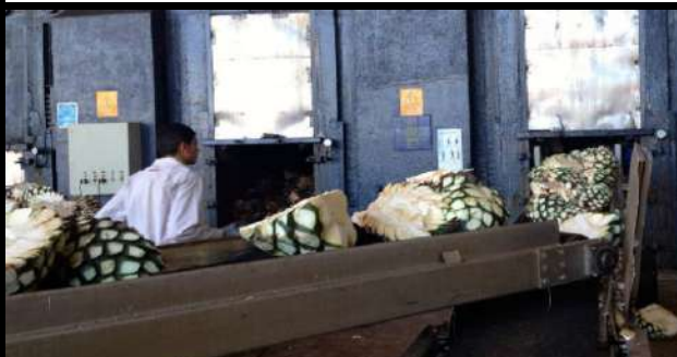
Az 55 tonna kapacitású kemencékben 36 órán keresztül hevítik az agavét 93°C-on
